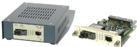
На лицевой стороне приборов, всех конструктивных исполнений, расположены оптический и Ethernet разъемы, а также светодиоды индикации. Разъем питания у всех исполнений находится с тыльной стороны прибора. На плате медиаконвертера расположен шестипозиционный DIP переключатель, позволяющий выбирать режим работы прибора.
