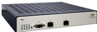
**TM-4** мультиплексирует 4xE1 тракта и передает их по одной медной паре на расстояние до 1.2 км. Встроенный сплиттер позволяет одновременно использовать ту же пару для обычной телефонной связи.
