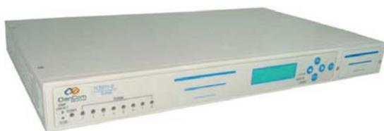
Устройство H3900-8 работает в паре (как master и slave). Ведомое устройство (slave) обычно располагается на стороне абонента. Расстояние, которое может покрыть данная технология, без репитеров, зависит от скорости передачи данных.
