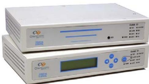
Устройство может использоваться для работы друг на друга в конфигурации «точка-точка», а также как клиентское терминальное устройство в паре со стационарным устройством H3900.
