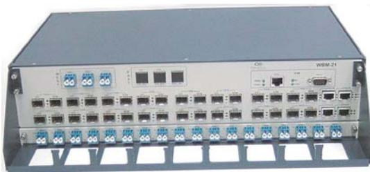
Система WBM-21-16 позволяет операторам связи создавать эффективные по стоимости, масштабируемые высокоскоростные транспортные сети для передачи любых сигналов со скоростью до 2,5 Гбит/с каждый.
